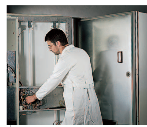
Alle an der Außentür vornehmbaren Vorgänge bewirken keinen Wärmeverlust, da die Innentür geschlossen bleibt und dadurch eine korrekte Isolierung garantiert wird.
